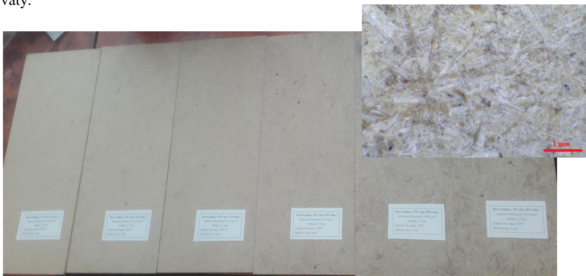
Obr. 3: Laboratórne vyrobené tenké kompozity drevné vlákno/PP hrúbky 3,2 mm. Obsah polypropylénu 5, 10, 15, 20, 30 a 40%. Detail na povrch vzorky- drevné vlákno/PP (10% hm).
