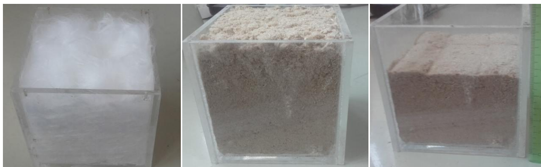
Obr. 2: Stanovenie špecifickej hmotnosti vstupných materiálov: a) zhutnená PP vata s objemovou hmotnosťou 0,048 \text{ g/cm}^3 , b) voľne sypané-vibrované drevné vlákno s objemovou hmotnosťou 0,075 \text{ g/cm}^3 , c) zhutnené drevné vlákno s objemovou hmotnosťou 0,125 \text{ g/cm}^3 .
