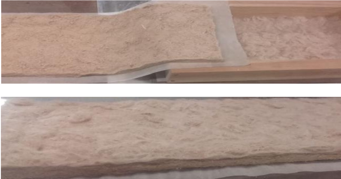
Obr. 5: Vrstvenie kompozitu drevovláknno/ PP: a) pohľad na pridávanie stredovej vrstvy, b) trojvrstvový koberec.
